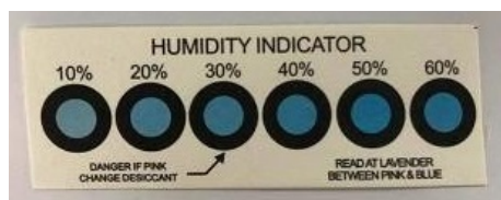
图 5-4 湿度卡的30%标识圈显示为蓝色
