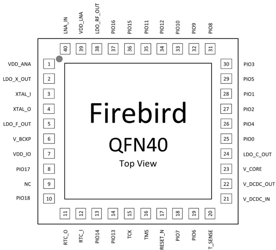
图 6-1 QFN40 管脚图
